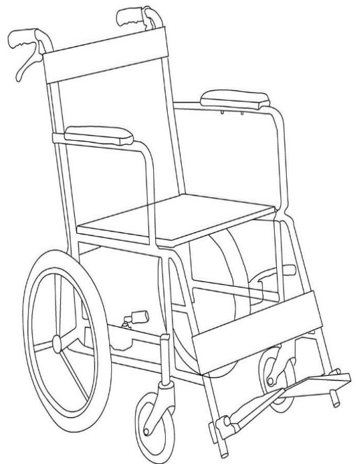
▲ 固定式骨架通过直接连结的方式，无可动关节
