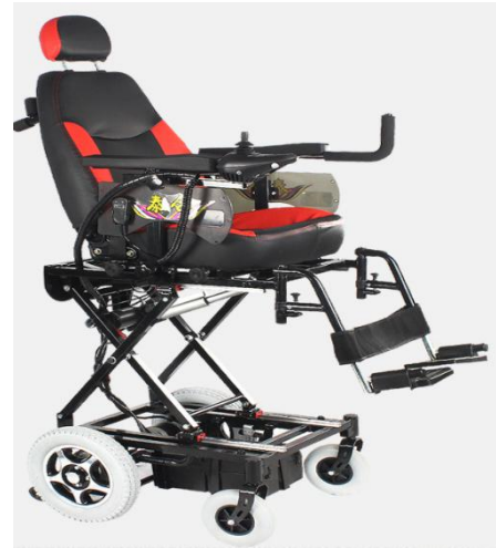
▲ 座面升降型座椅可 增加取物品的高度
