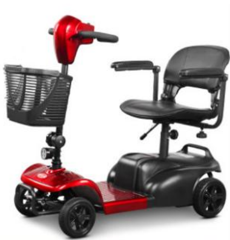
▲ 四轮电动代步车回转半径大，不利于室内使用
