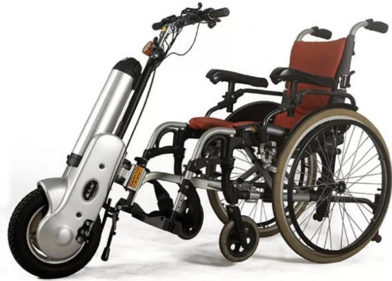
▲ 外挂拖曳式动力代步车仅在外出时才将动力机车头连接
